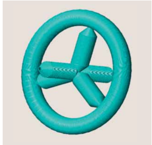
Вид сегмента космической станции, выполненного методами аддитивных технологий в условиях микрогравитации (расчетный диаметр 80 м) из рулонов углеткани, зафиксированных металлом методом магнетронного напыления
